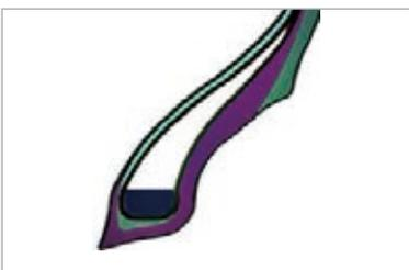
低滾阻三角膠配方設計，發熱低，提升雪地性能。
